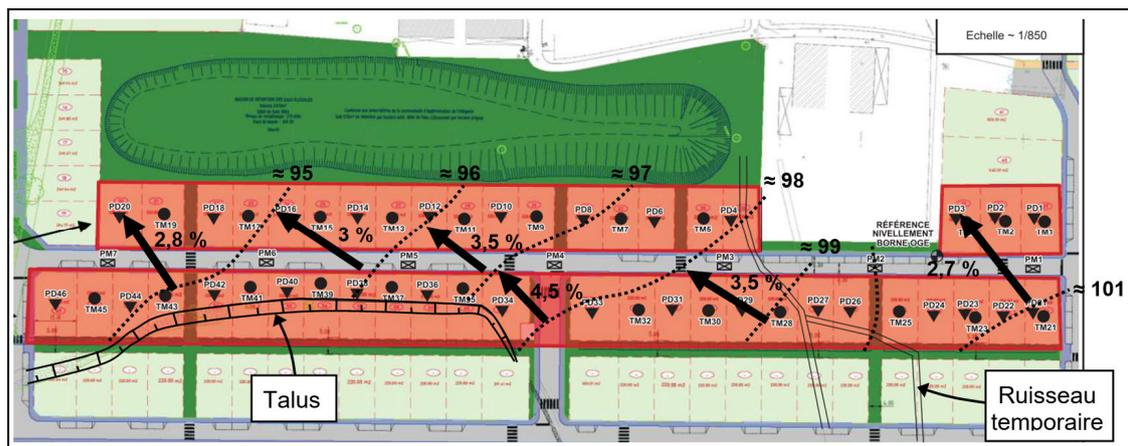
Topographie sommaire (attention : ce levé sommaire a été réalisé au simple niveau de chantier. Il reste uniquement destiné à faciliter la compréhension du contexte topographique et ne peut être utilisé pour un chiffrage quelconque des terrassements. Cotes altimétriques en mètres et non rattachées au NGF)
